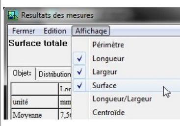
Les caractéristiques des grains se trouvent dans un tableau dont on peut choisir les caractéristiques représentées par les colonnes.
